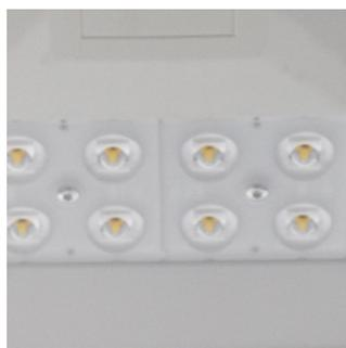
La PCB contiene una sonda NTC conectada al driver para control de sobrecalentamiento.
