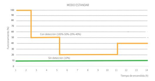
El sistema al captar presencia, aumentará su intensidad lumínica realizando la curva de regulación con detección. El valor en que el aumente la intensidad lumínica dependerá del escalón horario en el que se encuentre.
