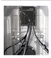
El controlador de carga incorpora un modo ahorro el cual protege a la batería por debajo del 20%, evitando las descargas profundas.
